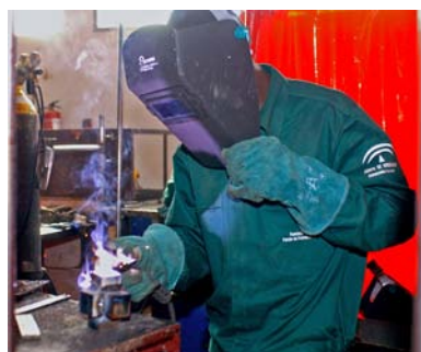
32. Soldadura con electrodos.
